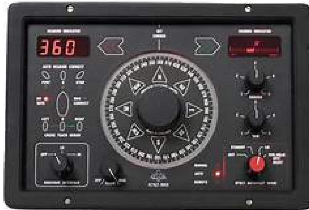
Navitron Autopilot Type NT921MKII
